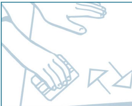
**INFO:** Da das im Klebstoff befindliche Restwasser nur langsam durch die Folie weg diffundiert, empfehlen wir, die Folienfläche nach 24 Stunden nachzurakeln, um die optimale Klebekraft zu erhalten.
