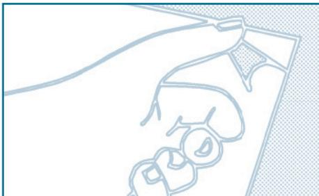
Emblem mit der Folienseite nach unten auf einen flachen, sauberen Untergrund legen. Das Schutzpapier an einer Ecke lösen und soweit flachabziehen, wie es bei den einzelnen Verklebe hinweisen angegeben wird.
