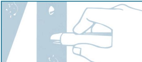
Die Folie um den Nietkopf herum gut mit der Kunststofffrakel oder der Nietbürste andrücken. Die Nietenköpfe mit geeigneter Farbe, z.B Siebdruckfarbe oder Fahrzeuglack, beifärben.
