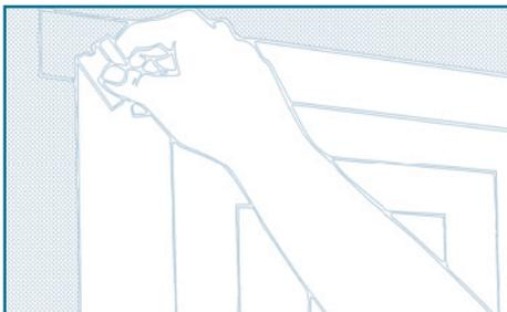
Das Klebeband an beiden Enden an der Folienkante mit dem Messer durchtrennen.
