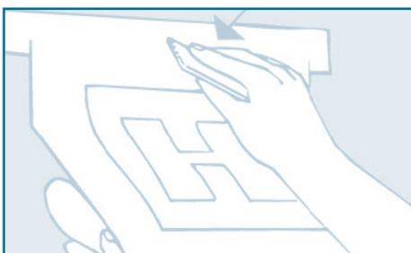
Die Folie zurückklappen ohne Kontakt über dem Untergrund haltend und, beim Scharnier beginnend, mit einem Handroller oder einer Kunststoffraker in überlappenden Strichen kräftig andrücken.
