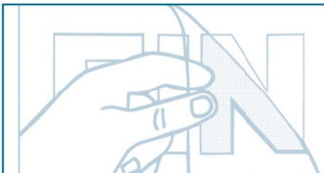
Übertragungsklebeband an einer Ecke lösen, umlegen und im Winkel von 180 langsam flach abziehen.
