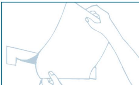
Die Folie um das Scharnier wenden und das Schutzpapier flach abziehen gegebenenfalls stückweise wie unter Punkt 6.2 gezeigt.
